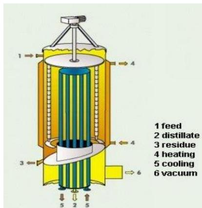
Vaporizatorul cu pelicula (denumit și "vaporizator cu pelicula subtire") constă din două ansambluri principale:
