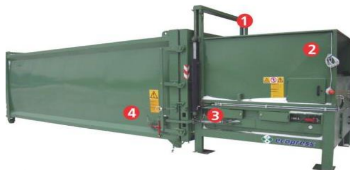
(1. ghilotină care ridică și coboară ușa containerului; 2. compactor propriu-zis; 3. sistem hidraulic de prindere și fixare a containerului compactor; 4. container)
