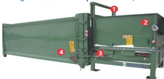
Figura 7-5 Sistem de compactare fix al deșeurilor
