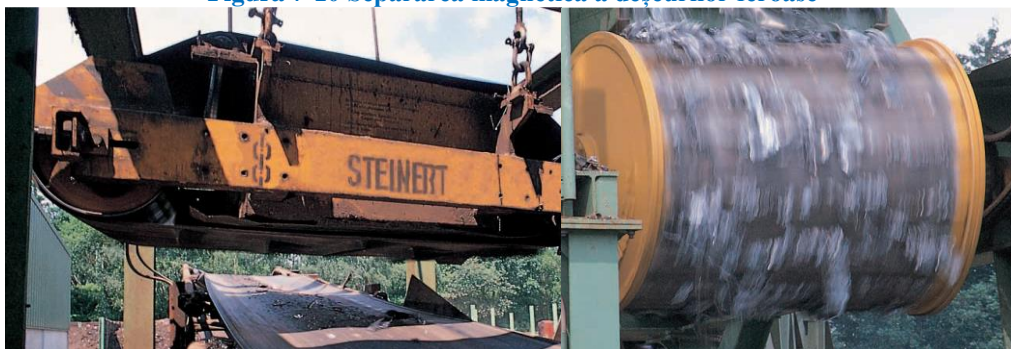
Figura 7-10 Separarea magnetică a deșeurilor feroase
