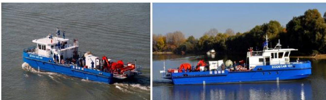
Figura VI.2. Nave de colectare a deșeurilor generate de nave. Stânga: ECOSTAR 100, aflată în portul Drobeta Turnu Severin; Dreapta: ECOSTAR 101, aflată în portul Giurgiu ( https://shipyardatg.ro/Inland-vessels/ ).
